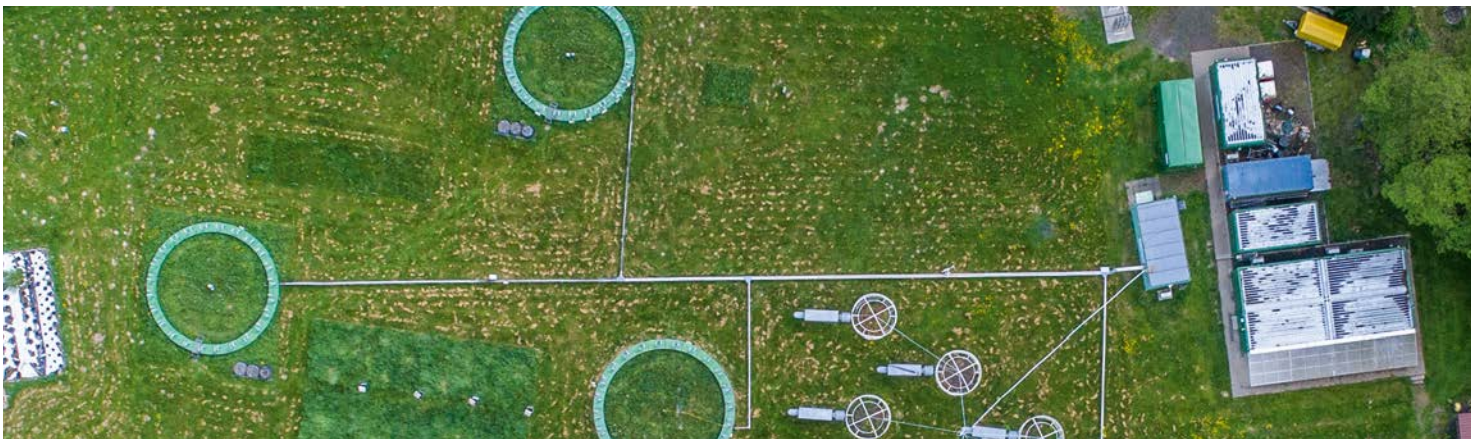
Abb. 20 Klimafolgenforschungsstation: Um Strategien zur Verminderung der Folgen des Klimawandels zu entwickeln, werden in der Klimafolgenforschungsstation in Linden mit Hilfe von CO 2 -Anreicherungsringen die Auswirkungen von Kohlendioxid auf Pflanzen, Böden und Tiere untersucht.
